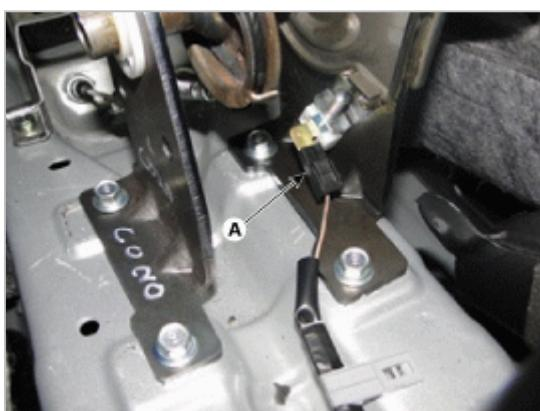
检查驻车制动开关的导通性。
